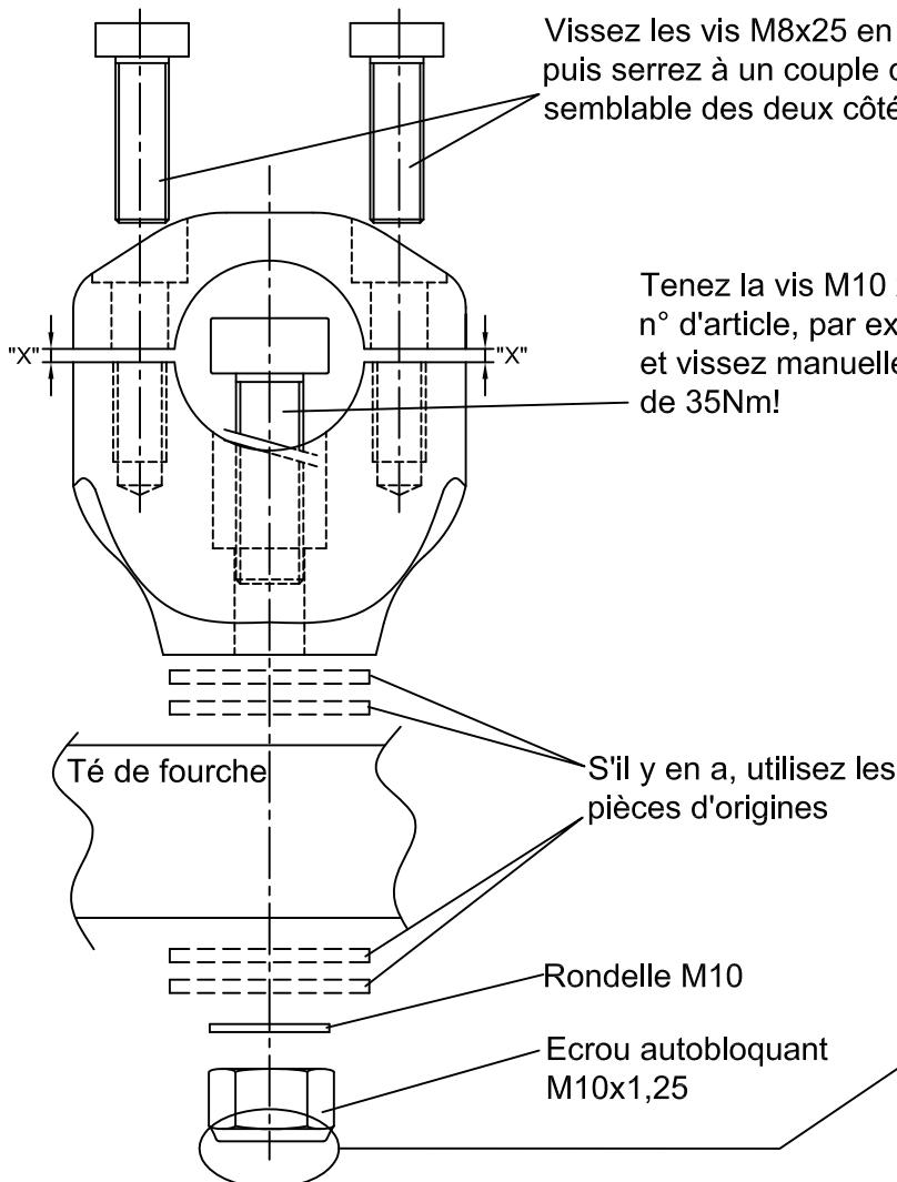
Vissez les vis M8x25 en alternance et de manière régulière, puis serrez à un couple de 25Nm! L'écartement "X" doit être semblable des deux côtés!
